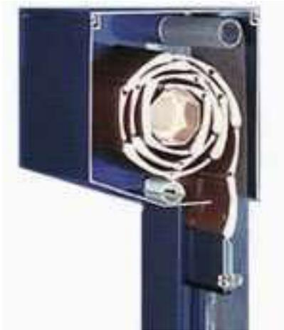
Das Insektenschutzgitter befindet sich auf einer separaten Federwelle, wandseitig oben im Kasten. Die Federwelle ist so vorgespannt, daß der Insektenschutzbehang problemlos nach oben läuft. In der Insektenschutz-Nut der Führungsschiene sitzt unten (jeweils in der linken und rechten Schiene) ein Hartplastikarretierer, in den die Fliegengitter-Endschiene einschnappt und gehalten wird. Durch leichte Bewegung der Endschiene nach unten wird das Fliegengitter freigegeben und kann hochfahren.
